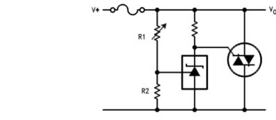
$$V_{LIMIT} \approx \left(1 + \frac{R1}{R2}\right) V_{REF}$$
